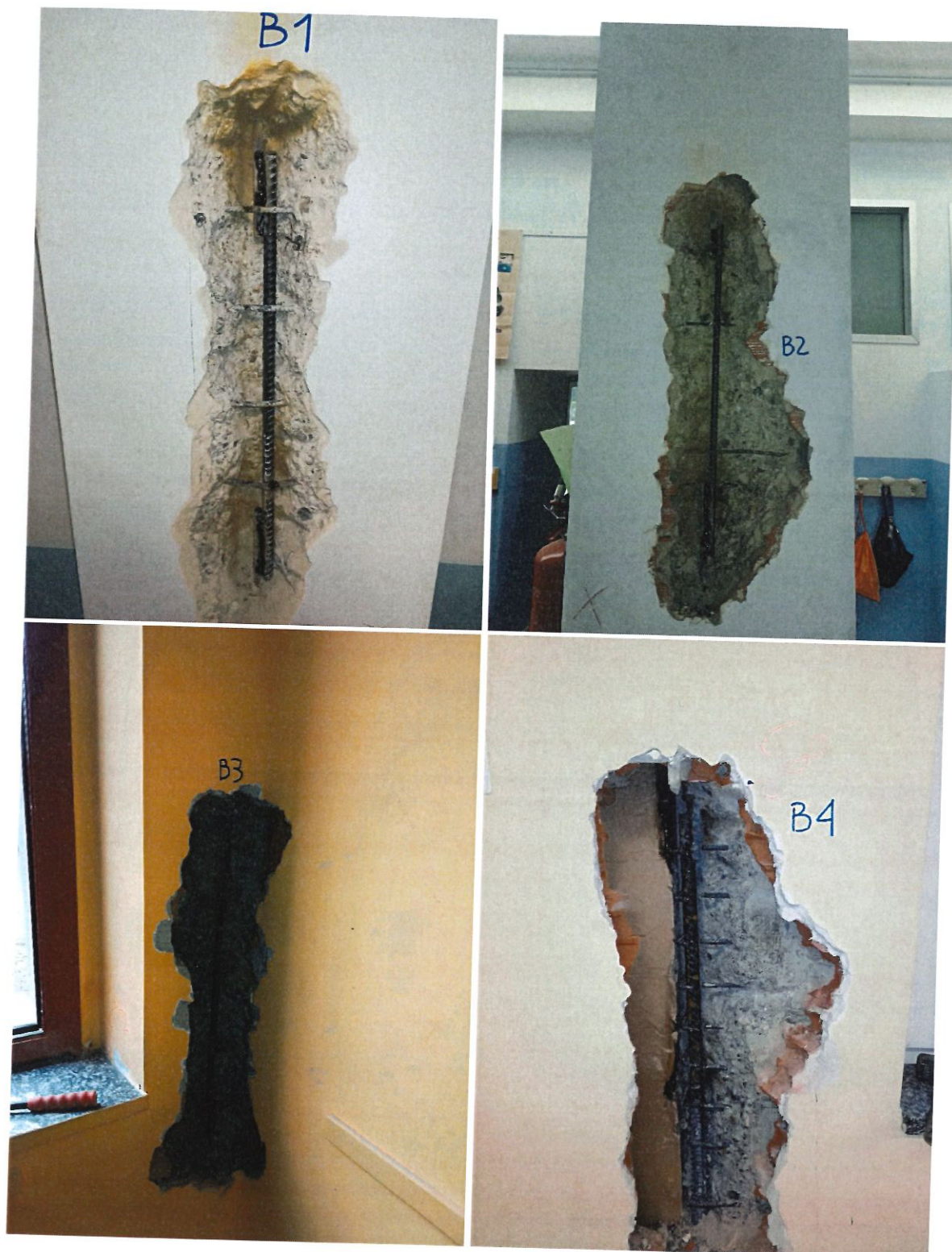
Prelievi di barra d'armatura B1, B2, B3 e B4
